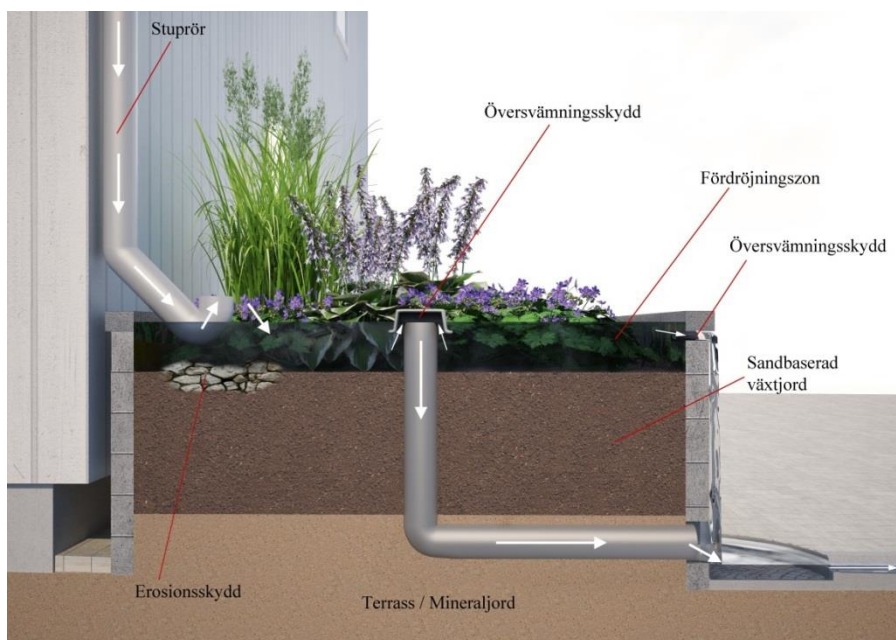
Figur 15. Biofilter, Kristian Klasson & Kent Fridell Tengbomgruppen AB, 2014.
