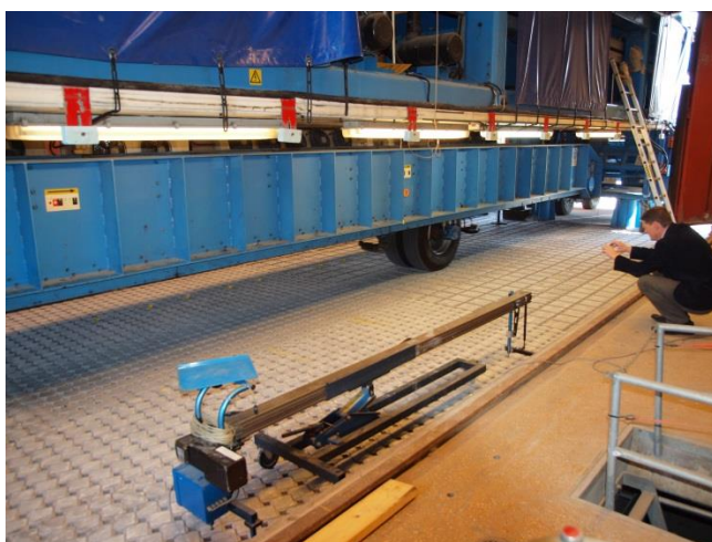
Figur 5. VTIs HVS-maskin i Linköping. Här på en dränerande beläggning med slitsikt av markbetongsten med stora fogar. Nederst i bilden syns VTIs linjelaser för mätning av spårdjup.
