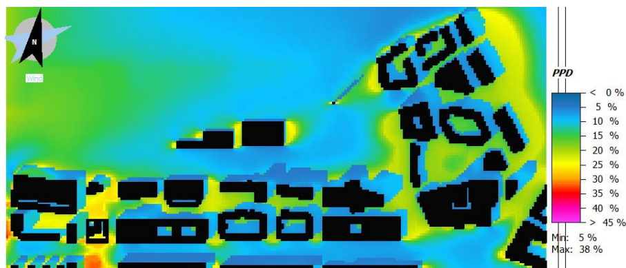
Figur 27. En mindre del av Masthuggsprojektet som visar var problem kan uppstå med för kraftiga vindar (mörkare röda delar).
