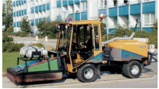
Stålbörste och ogräsbrännare.
